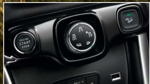
riesgo de derrape o aceleración del vehículo en descensos, tanto circulando hacia delante como en marcha atrás. Esta función se activa mediante un botón específico situado en la consola central.
